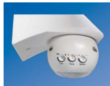
Установка с обратной стороны сенсорной головки уровня освещенности (Lux), длительности освещения (Time) и дальности контроля (Meter) производится 3-мя потенциометрами.
