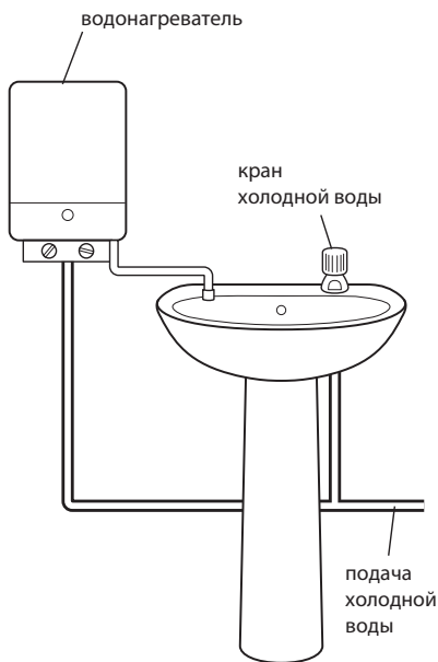
Рис. 2.14 Место установки одного из индивидуальных проточных водонагревателей
