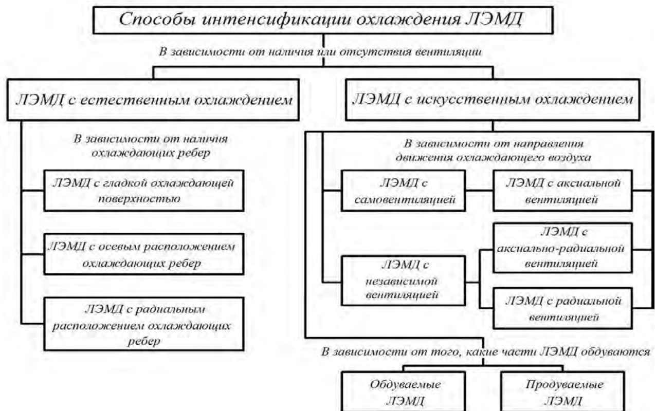
Рисунок 4.10 – Классификация способов интенсификации охлаждения ЛЭМД
