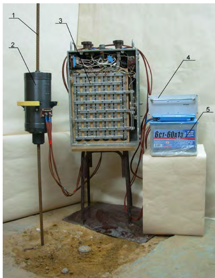
1 – забиваемый стержень, 2 – электромагнитная ударная машина, 3 – электрический преобразователь с емкостным накопителем энергии, 4 – конвертор, 5 – аккумуляторный источник питания
