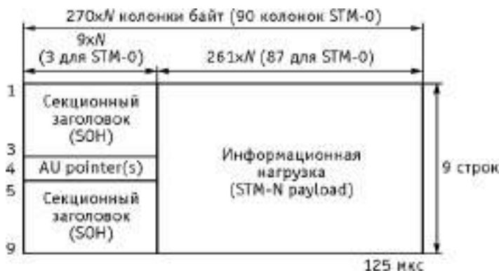
Рис. 3.1. Структура цикла STM-N
