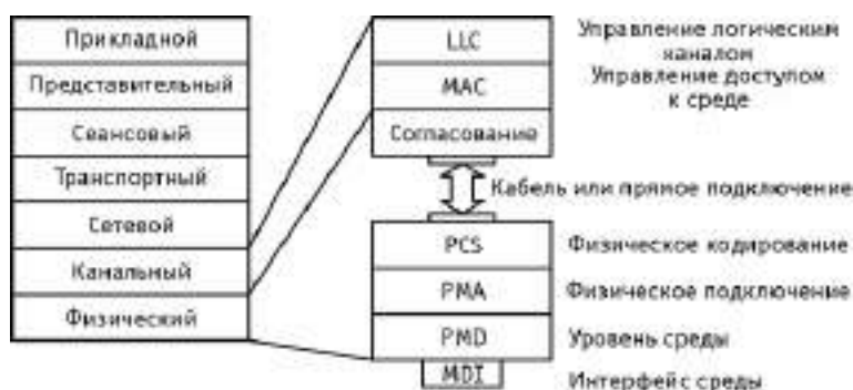
Рис. 3.114. Протокольная структура Ethernet
