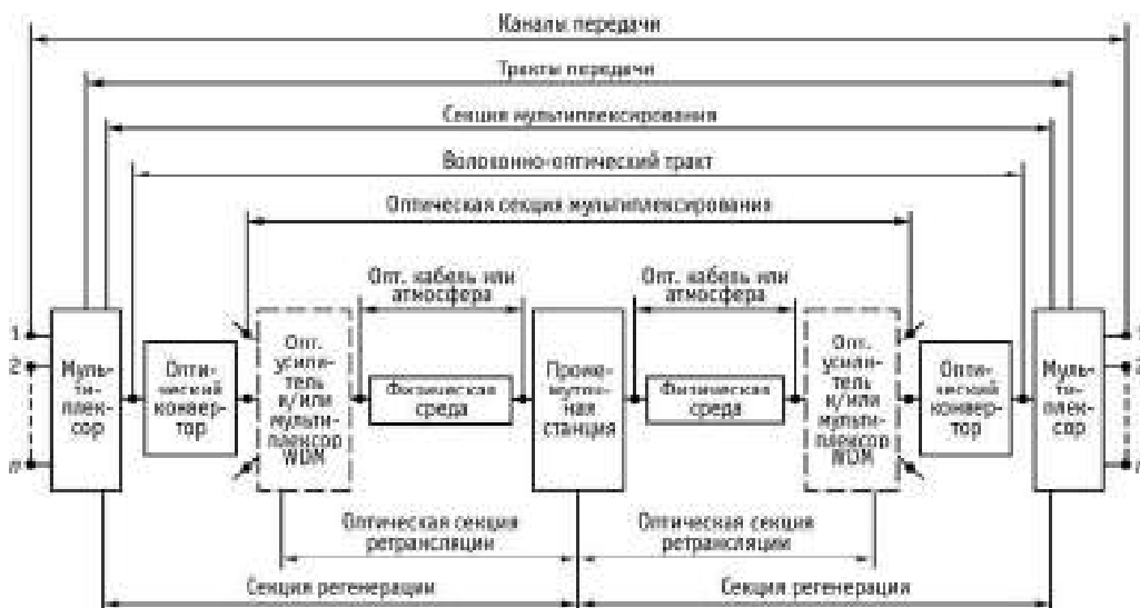
Рис. 1.1. Обобщенная схема оптической системы передачи
