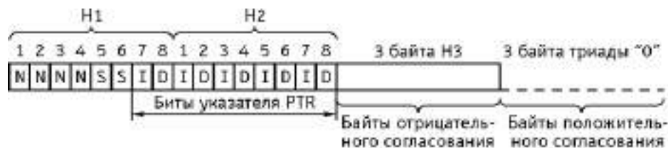
Рис. 3.38. Структура указателя (PTR) AU-4
