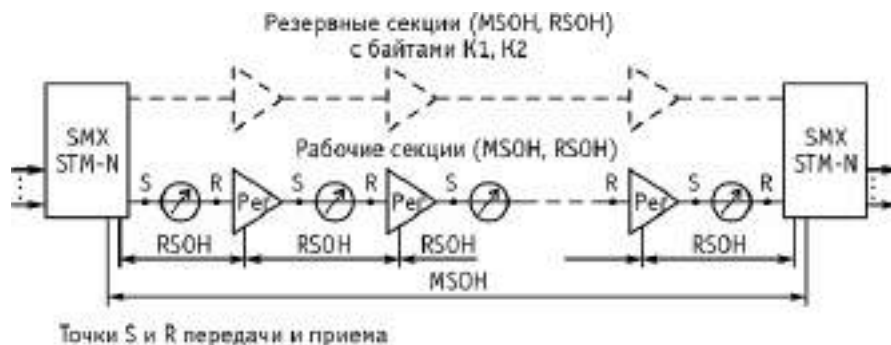
Рис. 3.37. Секционные заголовки и участки их применения в системе передачи
