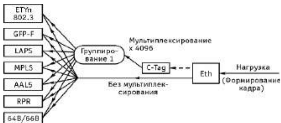
Рис. 3.123. Одноступенчатая схема мультиплексирования Ethernet
