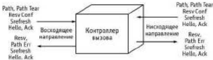
Рис. 5.62. Направления потоков сообщений GMPLS RSVP-TE
