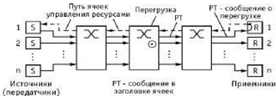
Рис. 3.72. Принцип работы схемы FECN
