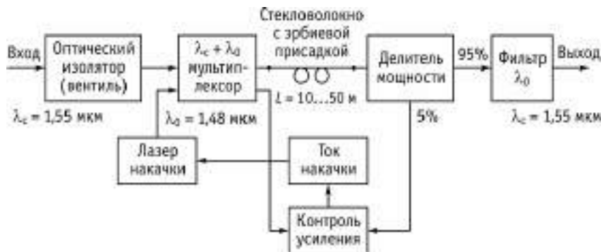
Рис. 4.3. Пример схемы эрбиевого оптического усилителя
