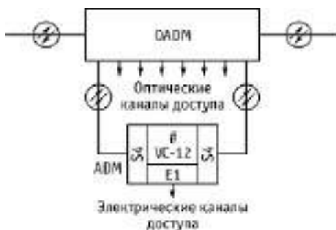
Рис. 5.6. Промежуточный сетевой элемент оптической сети с доступом к оптическим и электрическим каналам
