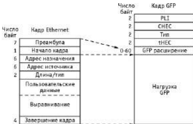
Рис. 3.137. Пример размещения нагрузки Ethernet в GFP
