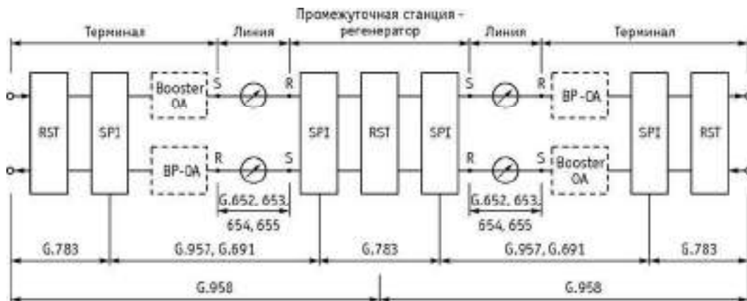
Рис. 6.2. Пример включения интерфейсов аппаратуры SDN для волоконно-оптической линии
