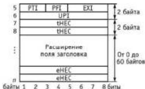
Рис. 3.134. Формат поля заголовка пользовательской нагрузки GFP
