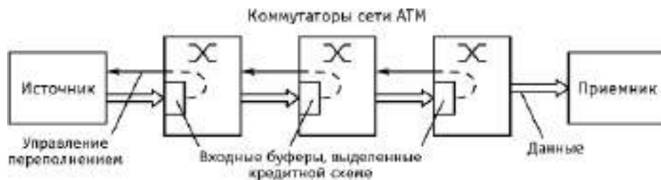
Рис. 3.71. Кредитная схема управления потоком ячеек
