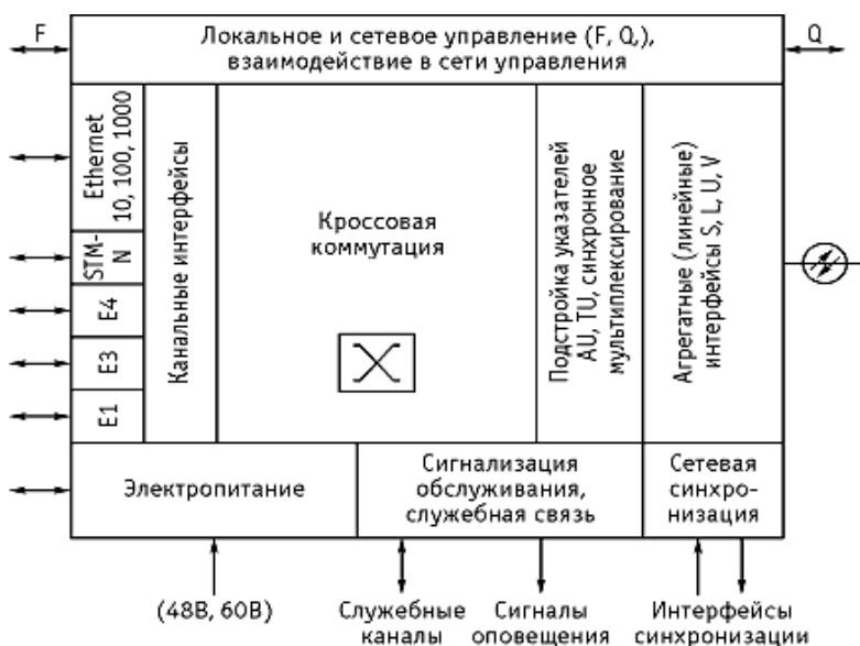
Рис. 1.4. Общая структура аппаратуры транспортных сетей
