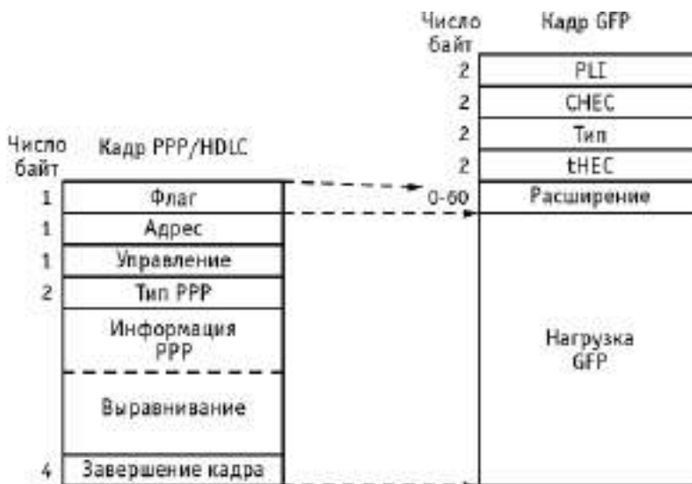
Рис. 3.138. Пример размещения нагрузки PPP/HDLC в GFP
