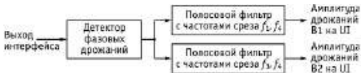
Рис. 5.32. Схема измерений фазовых дрожаний
