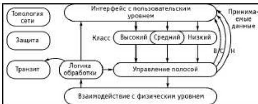
Рис. 3.142. Функциональные блоки MAC RPR
