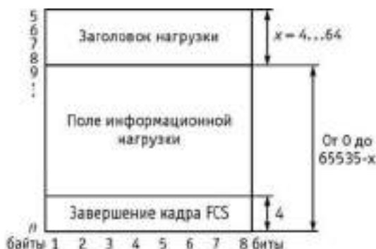
Рис. 3.133. Формат полей пользовательской нагрузки GFP
