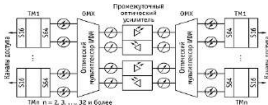
Рис. 5.2. Структура «точка-точка», образованная терминальными мультиплексорами SDH (STM-64) и оптическими мультиплексорами с числом волновых каналов n
