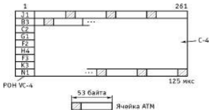
Рис. 3.21. Синхронное заполнение поля нагрузки VC-4 ячейками ATM
