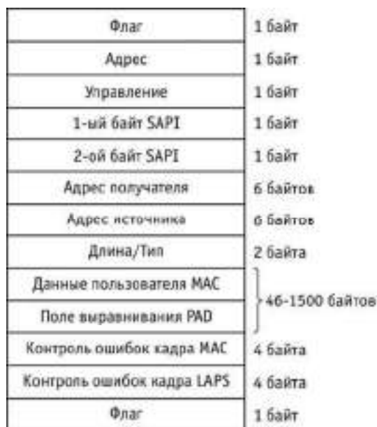
Рис. 3.130. Кадр LAPS с размещенными (инкапсулированными) данными кадра MAC Ethernet
