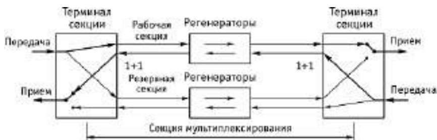
Рис. 5.17. Принцип резервирования секции 1+1
