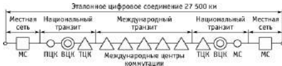
Рис. 5.29. Структура международного эталонного цифрового соединения:
