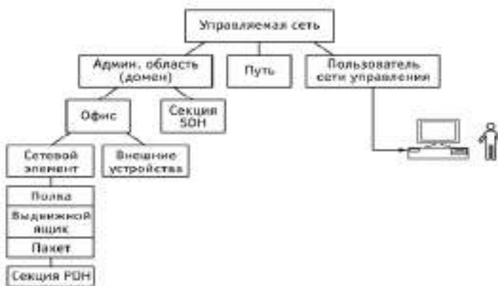
Рис. 5.46. Пример древовидной схемы объектов управления в транспортной сети SDN
