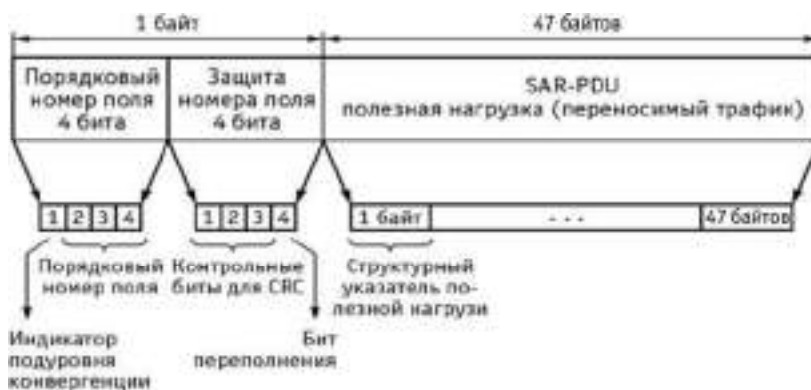
Рис. 3.53. Формат структурированных данных в ААL-1
