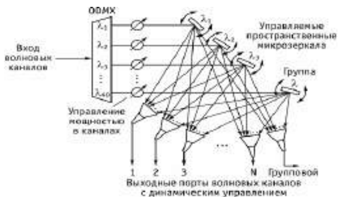
Рис. 5.27. Пример общего построения динамически управляемого частотного селектора-коммутатора
