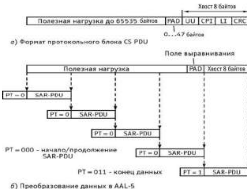
Рис. 3.60. Протокольный блок и преобразование данных в AAL-5 UU (User-to-User) — поле индикатора «пользователь-пользователь»
