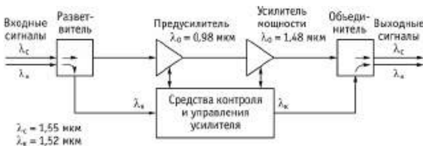
Рис. 4.4. Упрощенная схема сетевого элемента с оптическими усилителями
