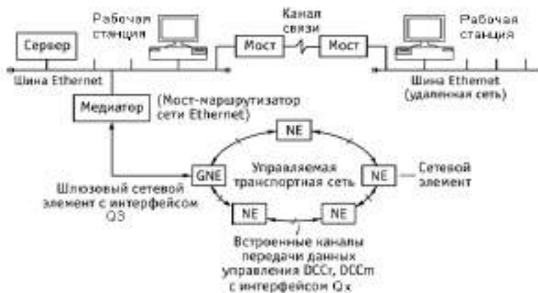
Рис. 5.44. Физическая структура сети управления транспортной сетью SDH
