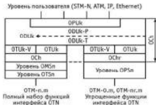
Рис. 3.82. Структура интерфейса OTN-OTN
