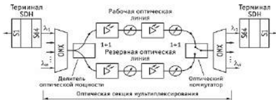
Рис. 5.19. Защита секции оптического мультиплексирования
