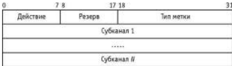
Рис. 5.60. Структура блока данных набора меток
