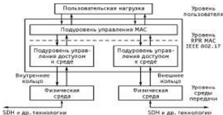
Рис. 3.141. Структура протокольных уровней RPR
