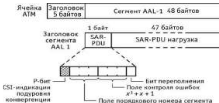
Рис. 3.54. Структура ячейки АТМ с сегментом ААL-1
