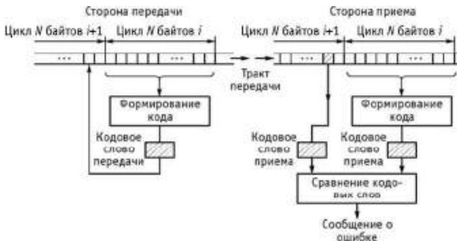
Рис. 3.14. Принцип контроля ошибок по алгоритму паритетного сравнения BIP
