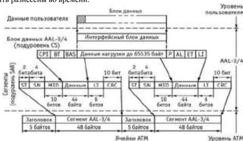
Рис. 3.58. Структура протокового блока данных AAL-3/4 для передачи сообщений
