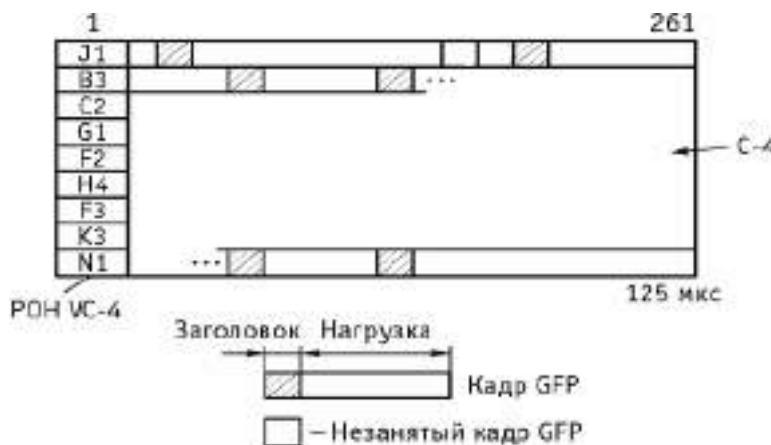
Рис. 3.22. Размещение кадров GFP в виртуальном контейнере VC-4
