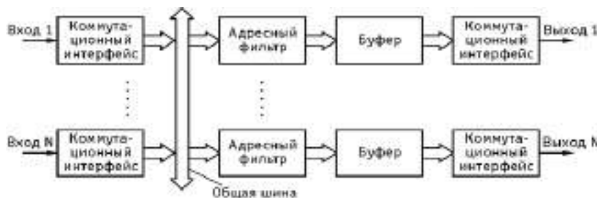
Рис. 3.62. Коммутатор с общей шиной
