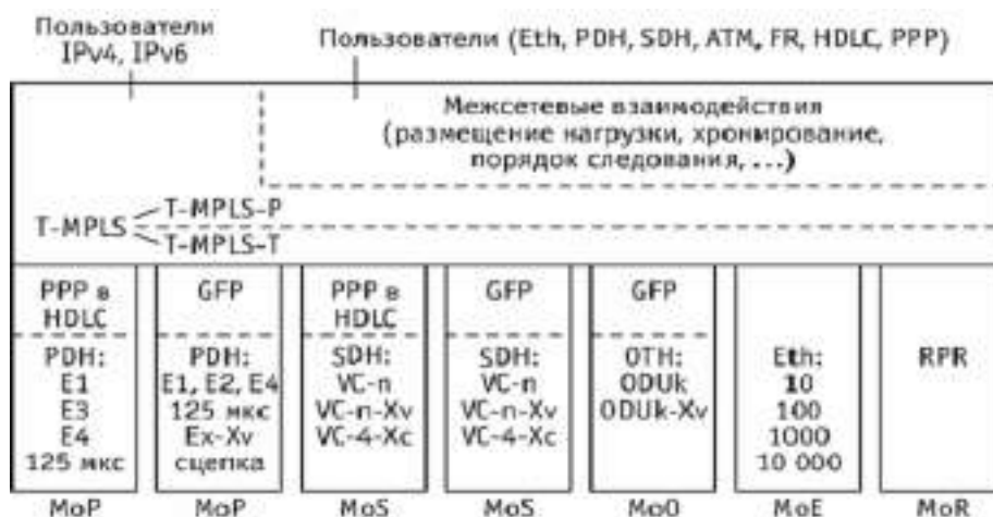
Рис. 3.127. Интерфейсы транспортного сетевого узла T-MPLS
