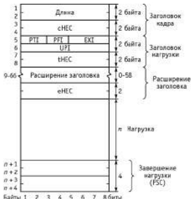
Рис. 3.135. Структура кадра управления GFP
