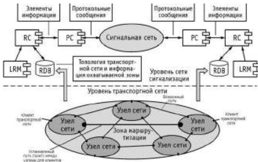
Рис. 5.56. Схема взаимодействия функциональных компонентов зоны маршрутизации транспортной сети и сигнальной сети ASON:
