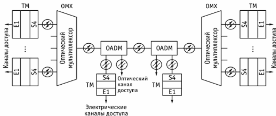
Рис. 5.5. Структура «оптическая линейная цепь»
