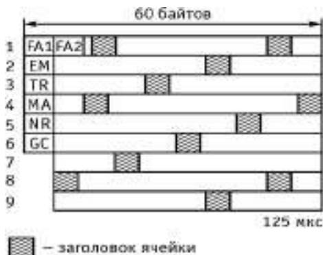
Рис. 3.79. Отображение ячеек АТМ в сигнале Е3 по Рекомендации G.832
