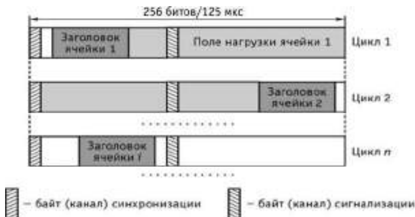
Рис. 3.78. Отображение ячеек АТМ в сигнале Е1
