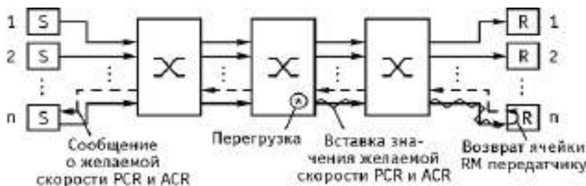
Рис. 3.75. Принцип работы схемы EPRCA
