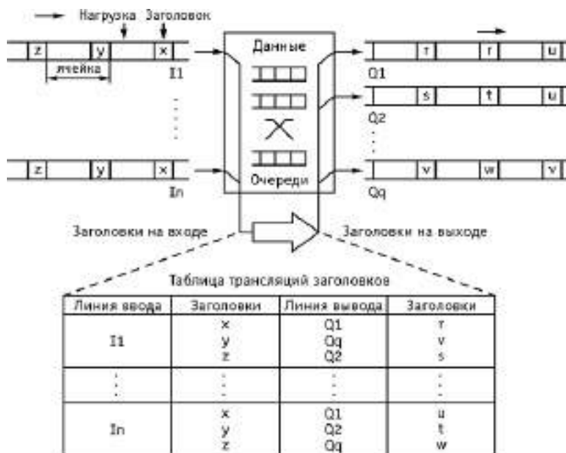
Рис. 3.61. Принцип коммутации в ATM
