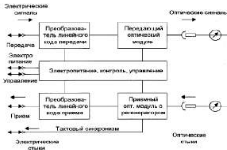
Рис. 1.2. Схема оптического конвертора
