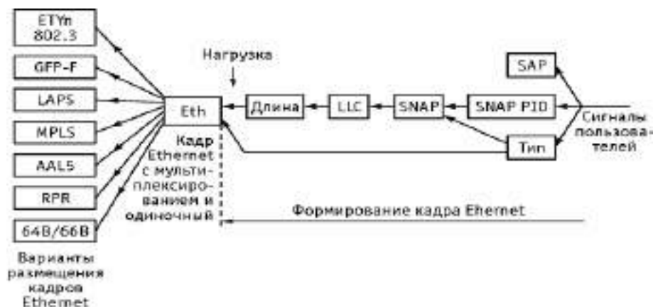
Рис. 3.122. Общая схема мультиплексирования Ethernet
