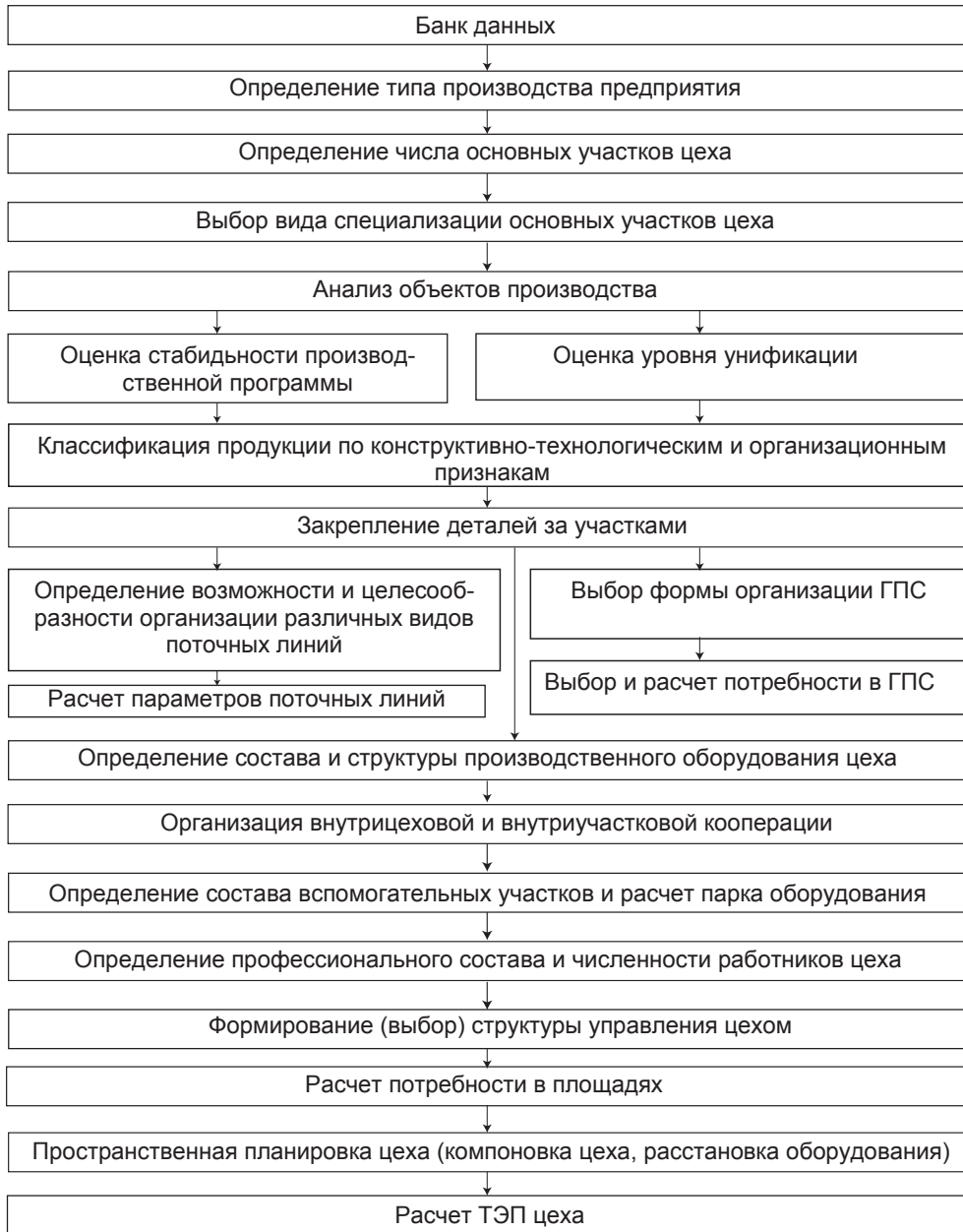
Рис. 5.2. Алгоритм проектирования организационной структуры цеха
