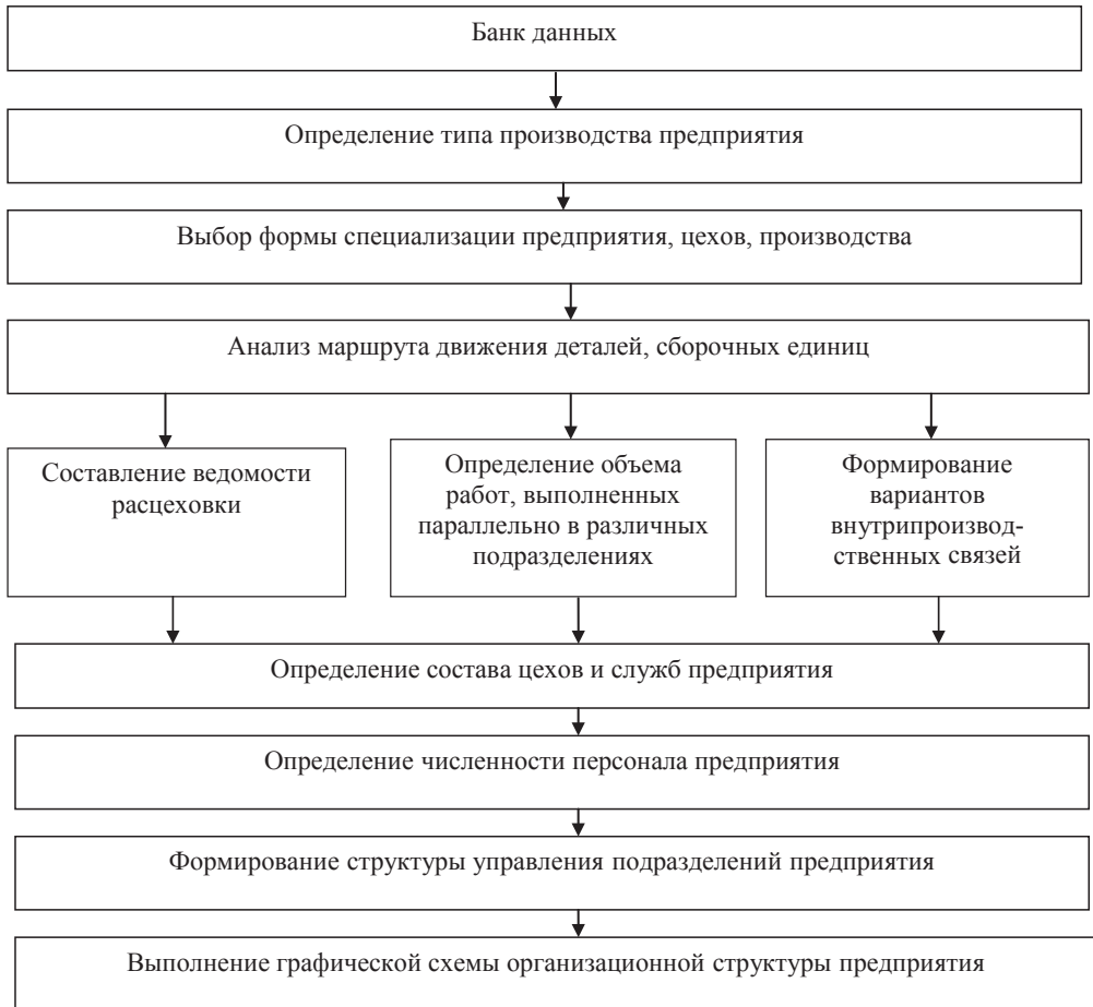
Рис. 5.1. Алгоритм проектирования основного производства
