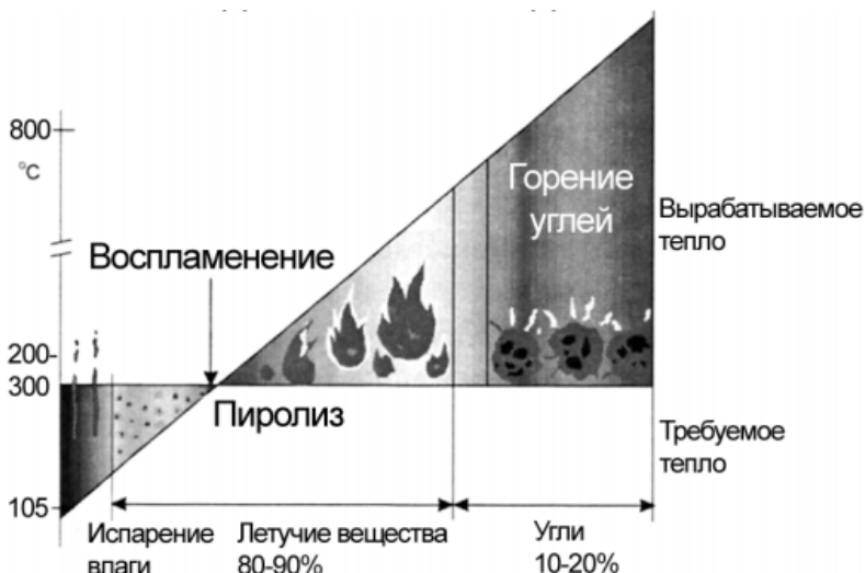
Рис. 1.1. Стадии сжигания твердого топлива
