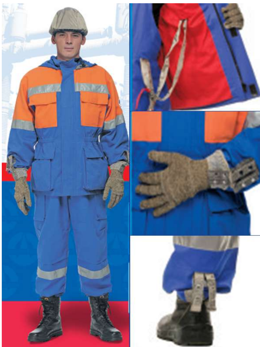
Рисунок 2.8 – Комплекты специальной одежды для защиты от наведенного напряжения. Комплекты изготавливаются с применением металлизированной электропроводящей ткани. Все электропроводящие элементы комплекта металлически соединяются друг с другом в единую электрическую схему
