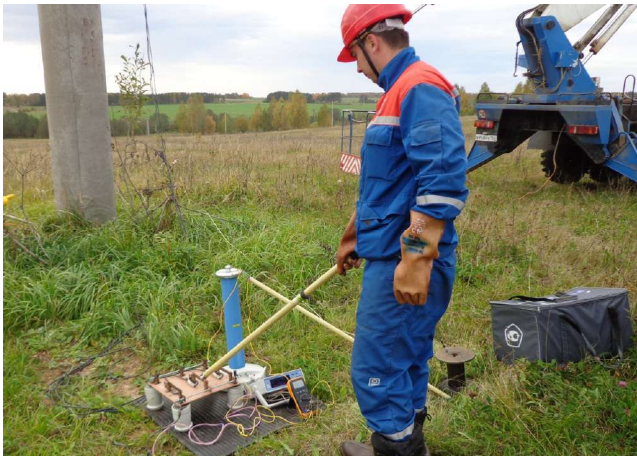
Рисунок 2.13 – Работы по измерению наведенного напряжения выполняются с применением защитных средств
