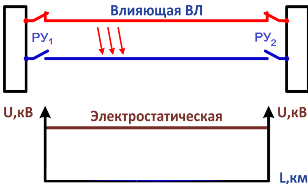
Рисунок 1.6 – При отсутствии заземлений на отключенной ВЛ появляется электростатическая составляющая наведенного напряжения, достигающая нескольких киловольт. Значение наведенного напряжения электростатической составляющей равномерно по всей трассе
