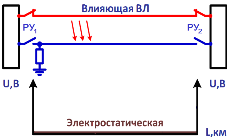
Рисунок 1.7 – При установке на отключенной ВЛ даже одного заземления электростатическая составляющая наведенного напряжения снижается до минимальных значений
