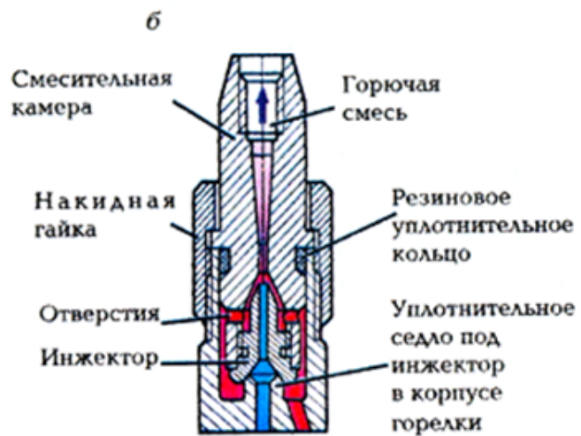
Рис.9. Инжекторная газовая горелка P2A-01: а - горелка; б - инжекторное устройство; 1-мундштук; 2 - nipple мундштука; 3 - наконечник; 4 - трубчатый мундштук; 5 - смесительная камера; 6 - резиновое кольцо; 7 - инжектор; 8 - накидная гайка; 9 - ацетиленовый вентиль; 10 -
