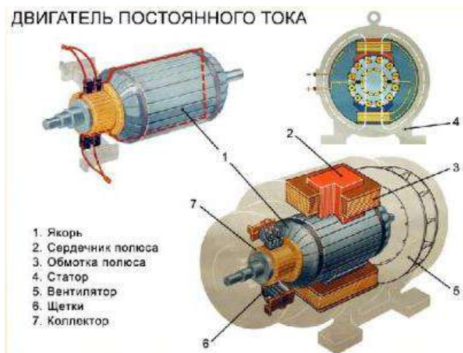
Рис. 3.13.1.2. Конструкция двигателя постоянного тока
