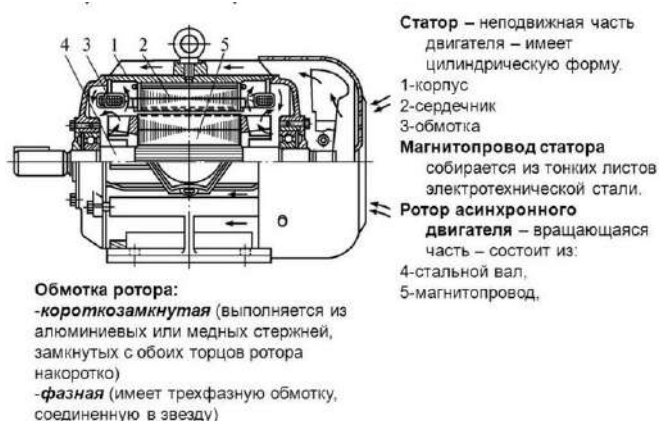
Рис. 3.11.1. Устройство асинхронного двигателя
