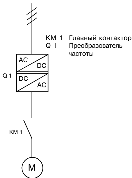
Схема одной линии при использовании преобразователя частоты
