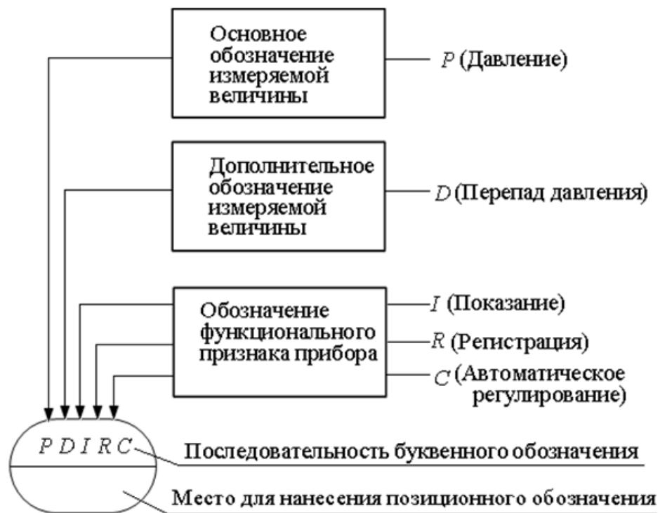
Рис. 3. Принцип построения условного обозначения прибора
