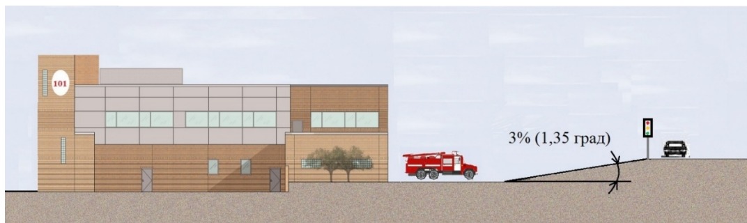
Рисунок 9.1 – Схема улаштування від'ємного ухилу виїзду зі стоянки-гаражу пожежного депо.
