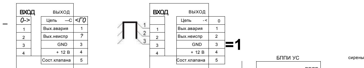
Типовая схема подключения пожарного извещателя к системе САКЗ-МК через БППИ УС
