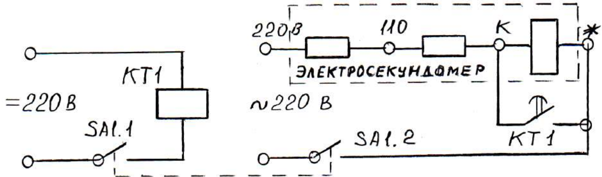
Рис. 1.7 – Схема для перевірки часу спрацьовування реле часу
