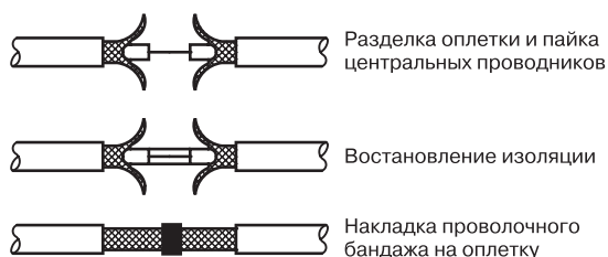
Рис. 11.13. Сращивание отрезков телевизионного кабеля в стык
