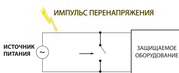
Рис. 8. Включение элемента защиты от перенапряжения параллельно с защищаемым оборудованием
