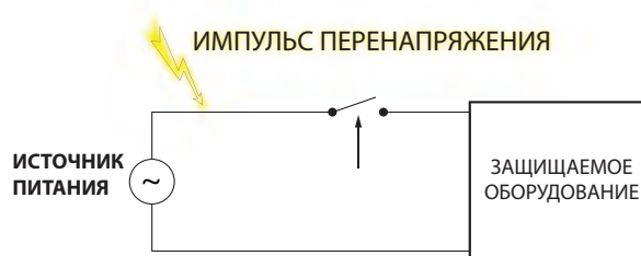
Рис. 7. Включение элемента защиты от перенапряжения последовательно с линией
