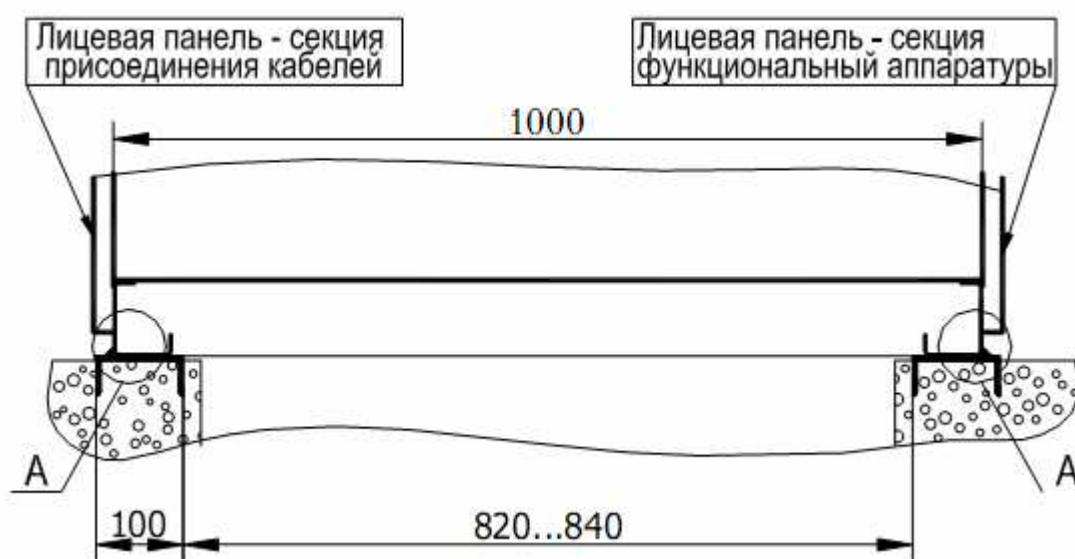
Рисунок 5.15 – Установка шкафов двухстороннего обслуживания
