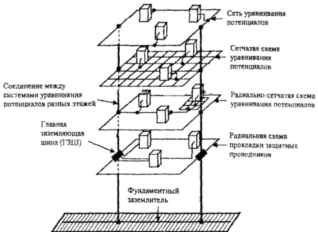
Рис. 16. Пример системы уравнивания потенциалов без присоединения молниезащиты
