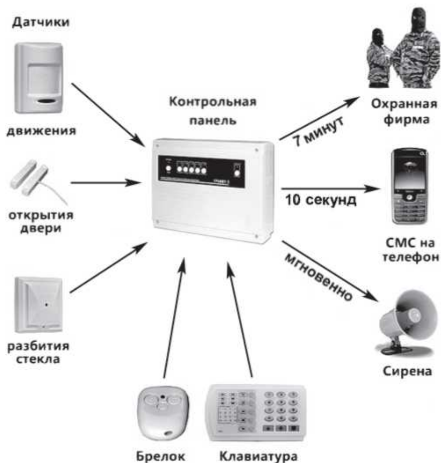
Рис. 1.1. Блок-схема центрального пульта охраны и других ее составляющих
