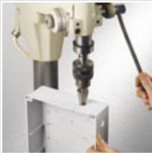
Кабельный ввод может быть просверлен индивидуально.
