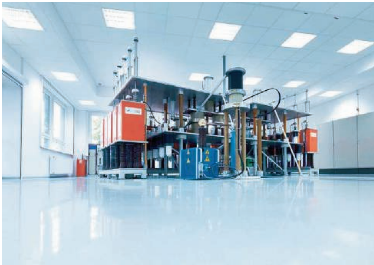
Испытание воздействием тока молнии
