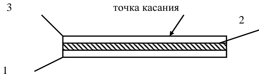
Рис.3.14. Сечение емкостного сенсорного экрана: 1 – стекло; 2 – проводящее покрытие; 3 – защитное покрытие.
