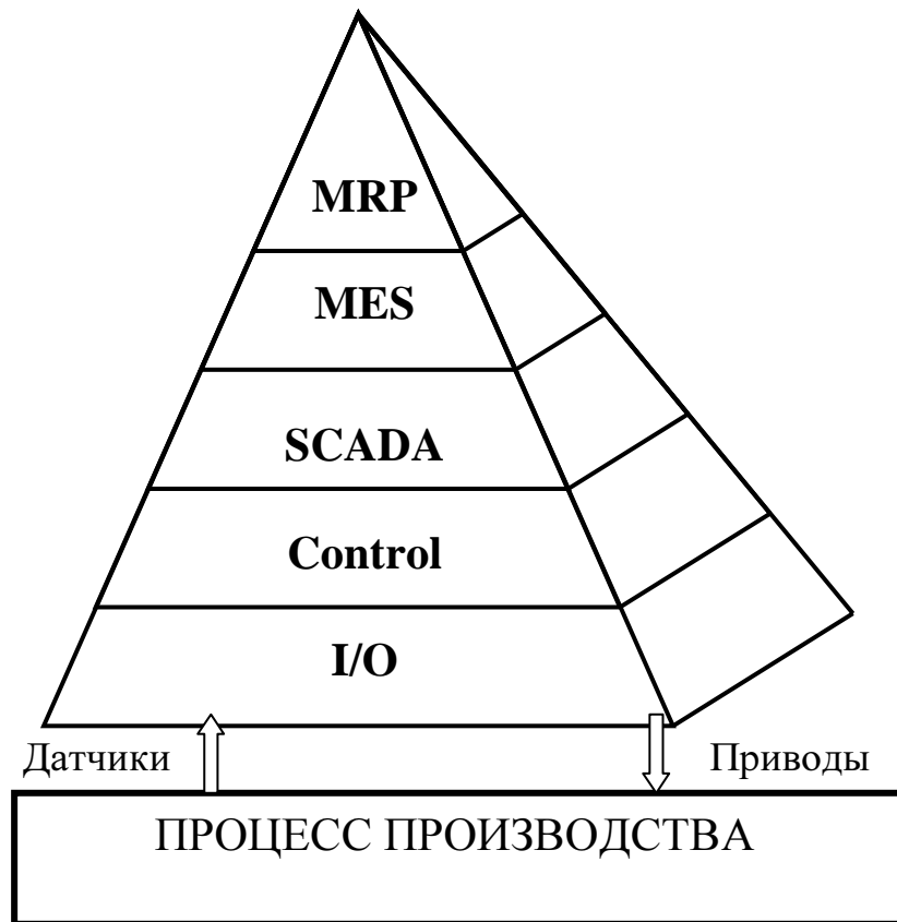
Рис. 1.10. Уровни автоматизации компьютерно-интегрированного производства
