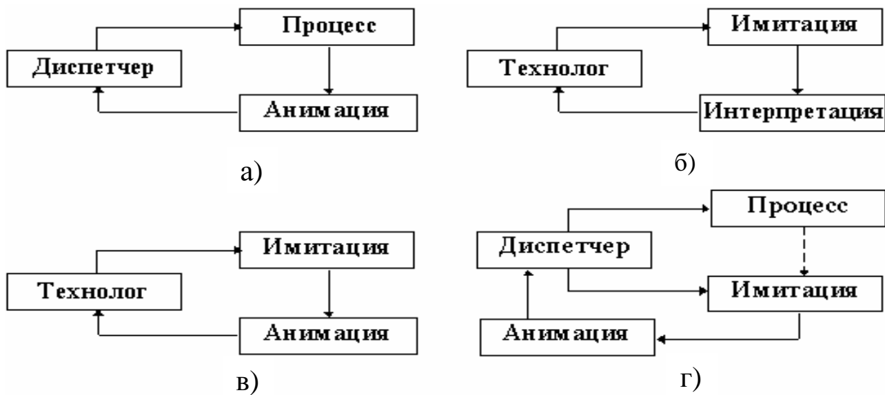
Рис. 6.20. Приложения имитации и анимации технологических процессов: а – управление в реальном времени по информации от датчиков; б – проектирование путем проведения имитационных экспериментов; в – проектирование путем имитации и анимации процесса; г – управление в реальном времени с синхронизацией реального процесса и его компьютерной модели
