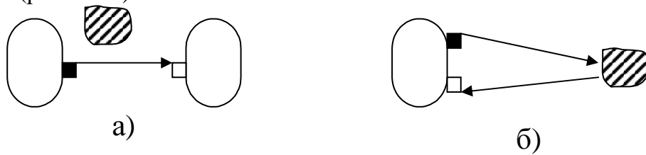
Рис. 2.17. Способы контроля положения объекта фотоэлектрическим датчиком: а – перекрытие оптического зазора; б – отражение от объекта
