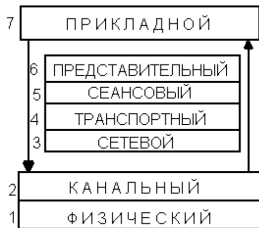
Рис. 5.3. Уровни протокола обмена информацией в промышленной шине
