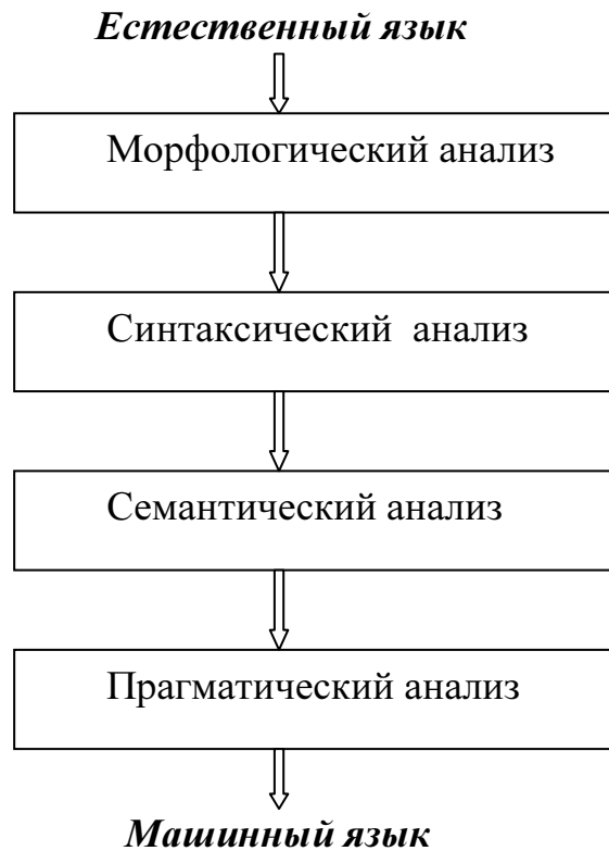
Рис. 6.2 . Преобразование информации на естественном языке в информацию на машинном языке
