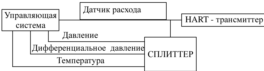
Рис.5.27. Применение сплиттера для выделения данных из аналогового сигнала
