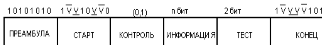
Рис. 5.14. Структура телеграммы в шине WorldFIP
