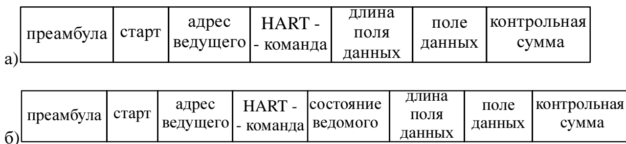
Рис.5.25. Структура HART-телеграммы: а- запрос ведущего устройства; б- ответ ведомого устройства
