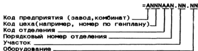
Например, =A102TK1.52.16 означает, что система вентиляции (16), участка обдирки (52) находится в отделении отделки ТК1 заготовительного стапа (номер по генплану 102) на предприятии А.
