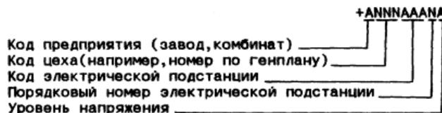
Например, =A114ETB2K означает цеховую трансформаторную подстанцию ЕТВ номер 2 напряжением 10 кВ, расположенную в здании, имеющем номер на генплане 114 на предприятии А.
