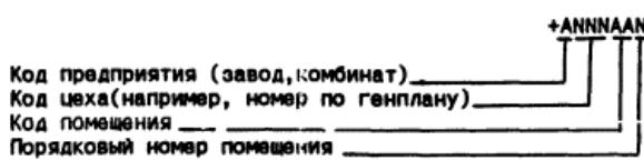
Например, +A114EE1 обозначает, что первое электротехническое помещение расположено в здании, имеющем номер на генплане 114 на предприятии А.
