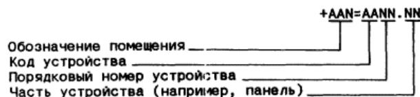
Например, +EE1=AC01.03 означает третью панель щита АС01, расположенного в первом электротехническом помещении.
