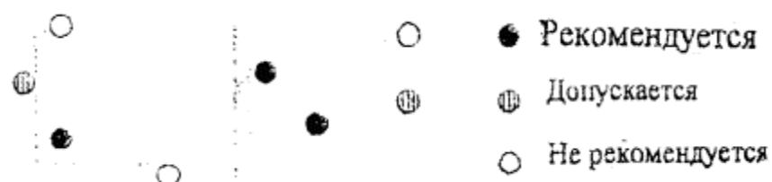
Рис. 24. Расположение кабелей внутри металлических профилей
