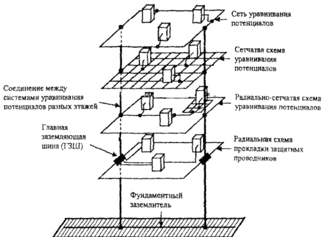
Рис. 16. Пример системы уравнивания потенциалов без присоединения молниезащиты
