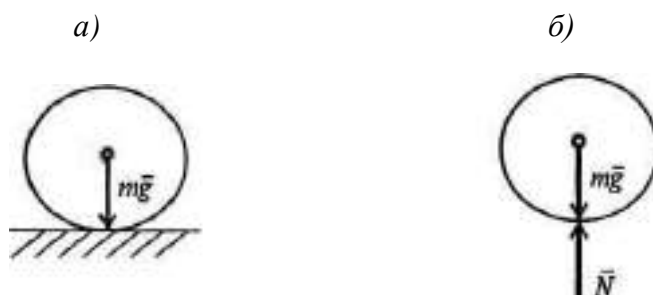
Рисунок 1.3 - Принцип освобождаемости твердого тела от связи
