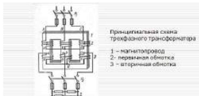
Рисунок 2.20 - Принципиальная схема трехфазного трансформатора
