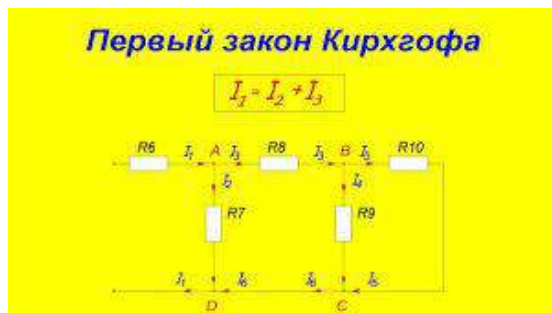
Рисунок 2.8 – Законы Кирхгофа
