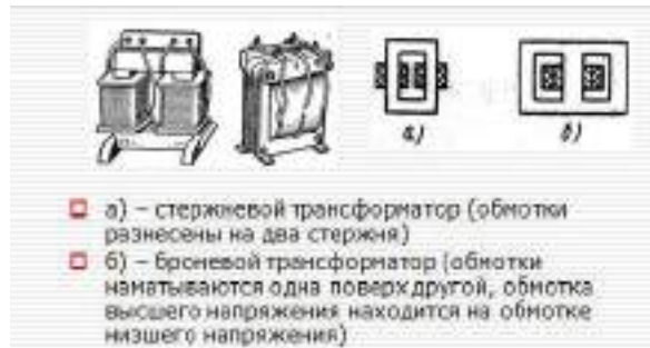
Рисунок 2.18 - Виды однофазных трансформаторов
