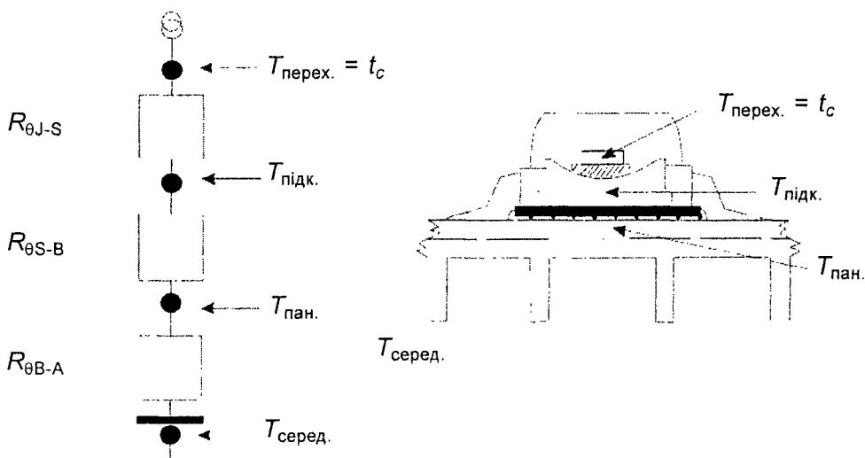
Рисунок 1 — Схематичний ескіз ланцюжка опірностей нагріванню
