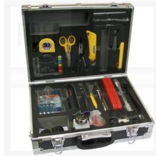
Рис. 7 - Набор инструментов для разделки ВОК
