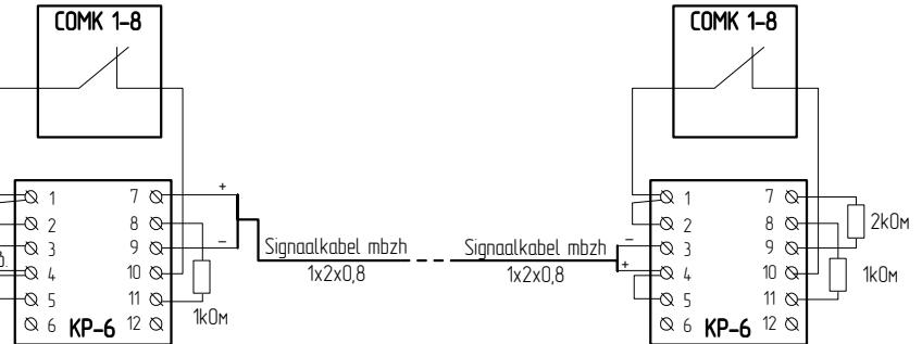
Типова схема підключення датчиків положення ПК ДППК-1
