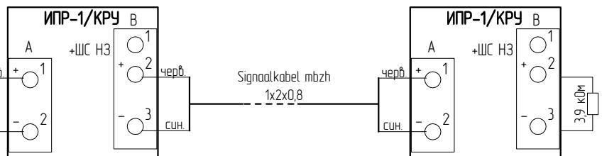
Типова схема підключення датчиків відчинення поежихніх шаф СОМК 1-8 в 2-х провідній шлейф сигналізації:
