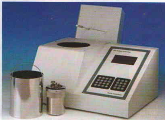
Фото 1. Ізоперіболічний бомбовий калориметр, який використовують для визначення теплоти згоряння неметалевих ізоляційних матеріалів кабелю за EN ISO 1716 [4]
