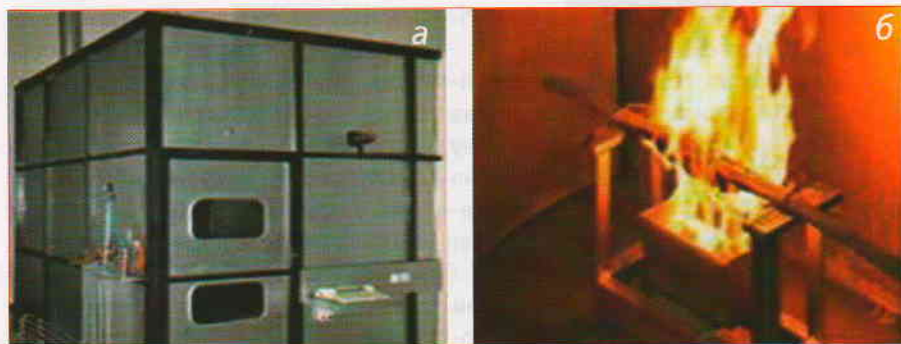
Рис. 1. Випробувальне устаткування, згідно з EN 50399 [6]: 1 — випробувальна камера розмірами (4,0 \times 1,0 \times 2,0) м, за EN 60332-3-10 [7]; 2 — отвір для подачі повітря; 3 — вихідний отвір для видалення продуктів згоряння; 4 — пропановий пальник стрічкового типу; 5 — стандартна випробувальна драбина; 6 — витяжний ковпак разом із повітроводом, в якому встановлено систему вимірювання динамічних характеристик тепловиділення та димоутворення
