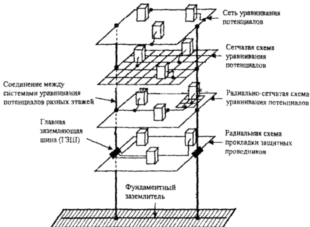
Рис. 16. Пример системы уравнивания потенциалов без присоединения молниезащиты
