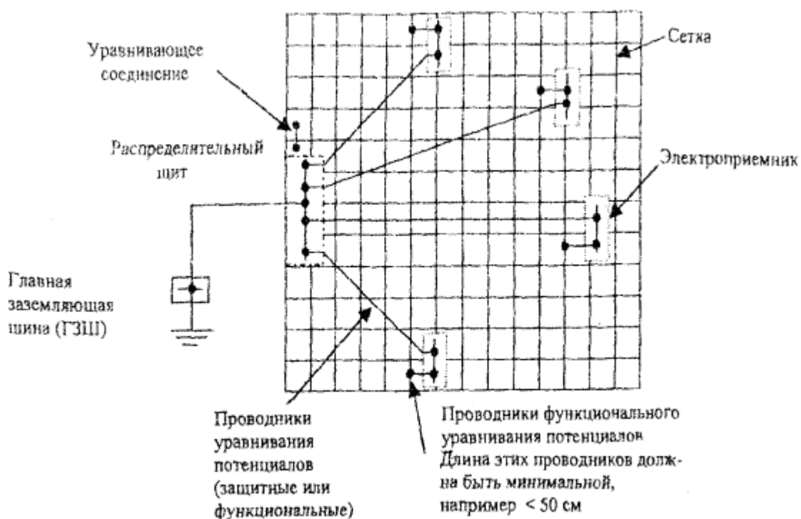
Рис. 15. Пример сетчато-радиальной системы уравнивания потенциалов (Основа - сетчатая структура большой площади, на которой размещена радиальная сеть)
