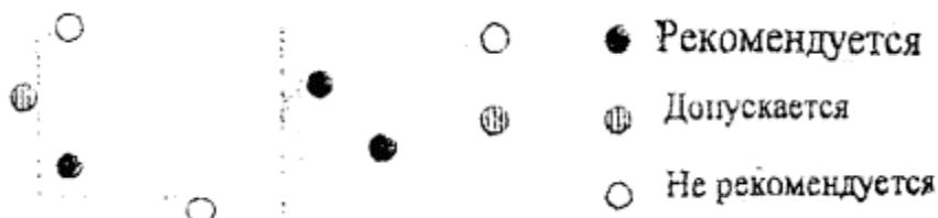
Рис. 24. Расположение кабелей внутри металлических профилей
