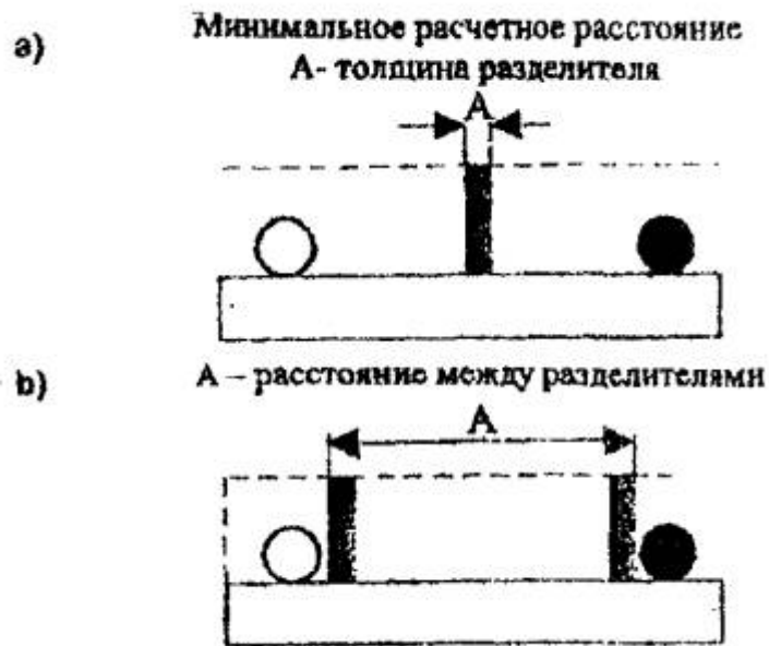
Рис. 19 в. Пример параллельной прокладки силовых и информационных кабелей, разделенных перегородкой (разделителем)
