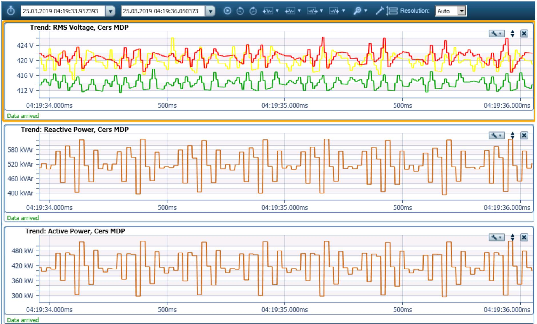
3. Включение ступени 50 кВАр обычной конденсаторной установки (контакторная, без дросселей). Значительный переходной процесс, может привести к сбоям в работе чувствительного оборудования, а также к ошибочному срабатыванию защитных устройств. Увеличение уровня гармонических искажений.
