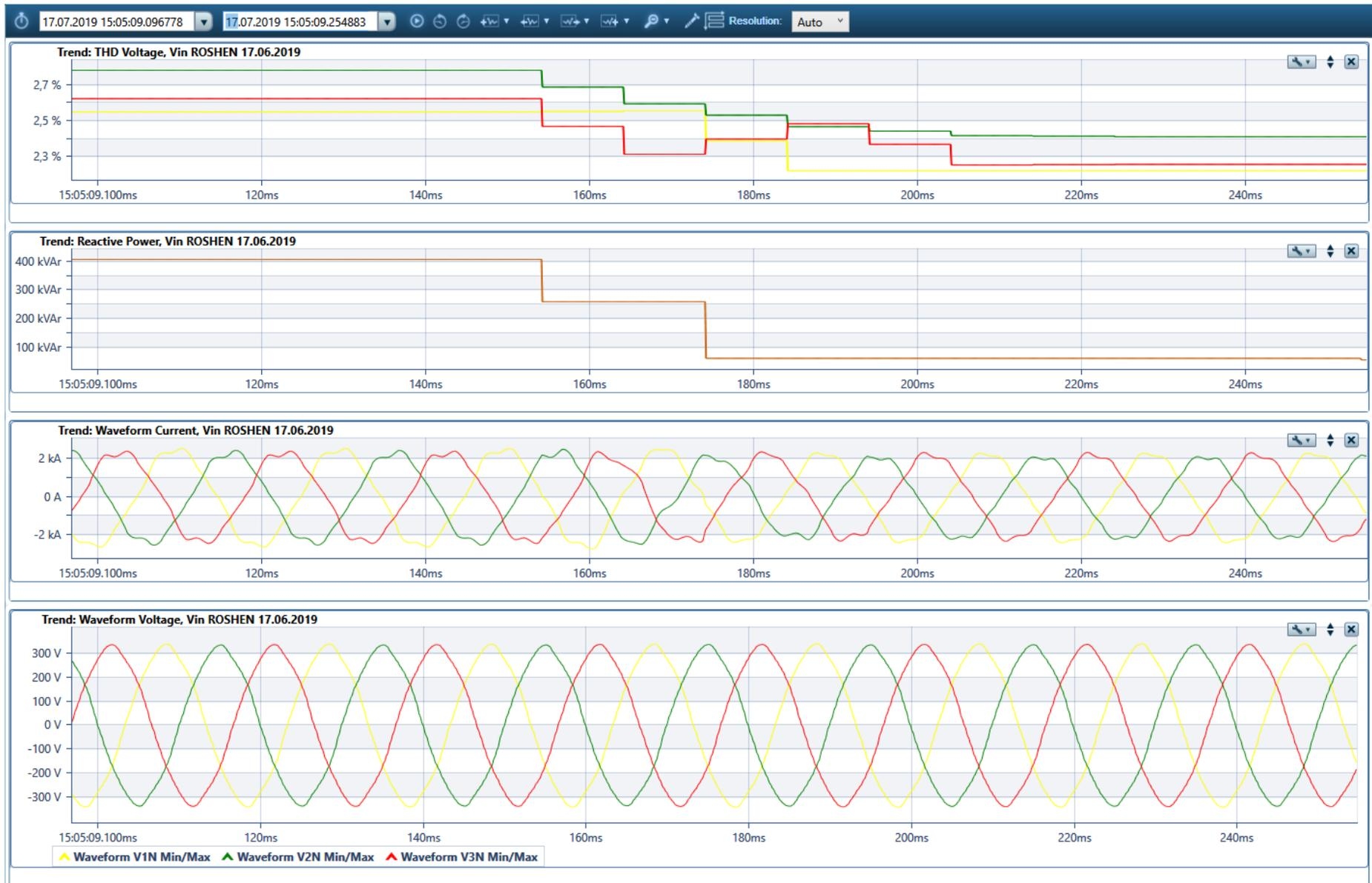
5. Измерения на выходе инвертора 500 кВт на одной из ФЭС. Проблемы с уровнем гармоник по напряжению. Проявляются уже в режиме холостого хода (имеет внешние причины).
