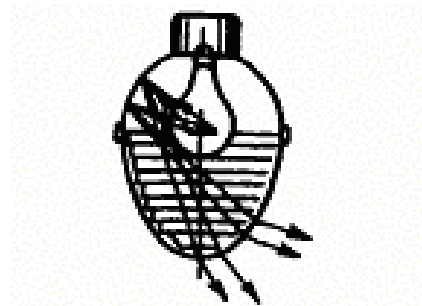
Рис.4.7 — Формування світлового пучка за допомогою заломлення і повного внутрішнього відбиття
