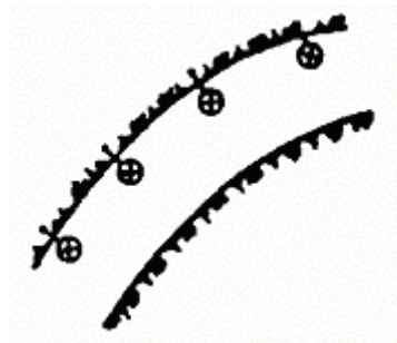
Рис. 7.3 — Розташування світильників на закругленні по зовнішній стороні
