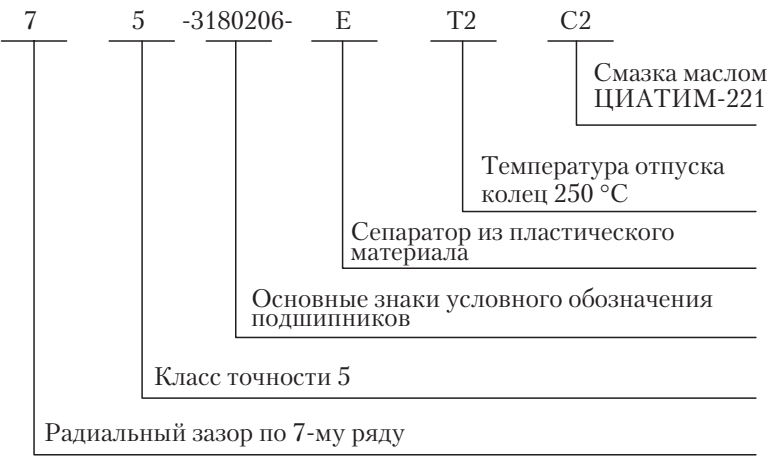
Рис. 10.9. Пример условного обозначения подшипника с дополнительными знаками
