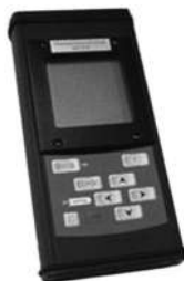
Рис. 8.2. Двухканальный анализатор параметров вибрации «Агат-М»
