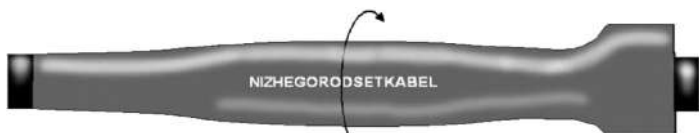
Рис. 12.21. Установка наружного шланга с усадкой
