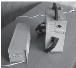
Рис. 9.8. Эндоскоп с блоком питания
