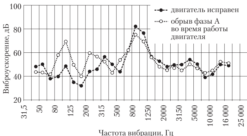
Рис. 7.9. Виброакустические характеристики асинхронного двигателя АМ-72-6
