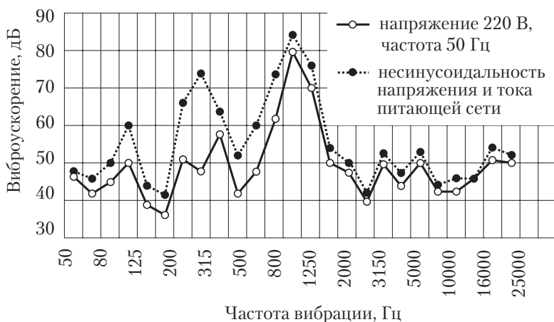
Рис. 7.3. Виброакустические характеристики асинхронного двигателя
