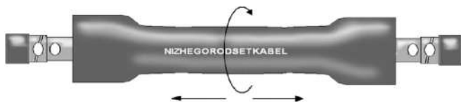
Рис. 12.19. Установка внутренней трубы и направление прогрева
